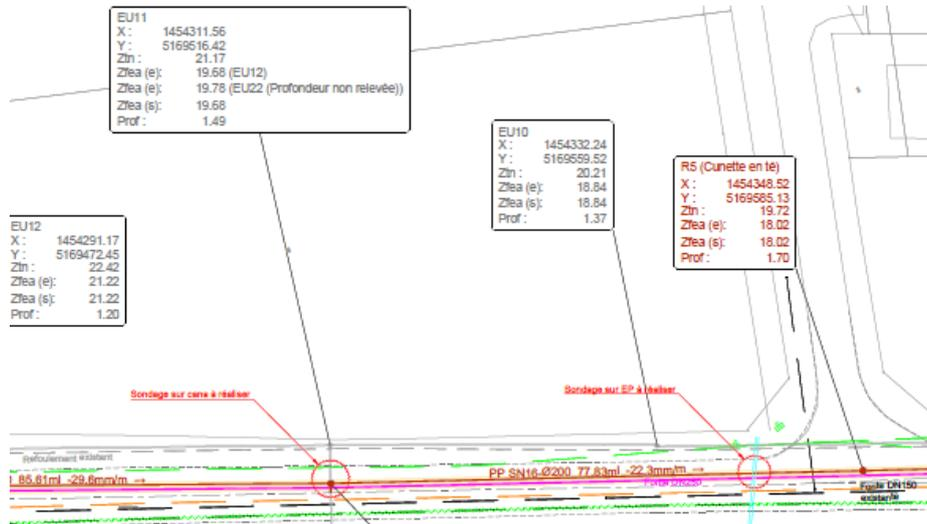
**Le 19/10**, validation de la reprise des branchements EU et AEP entre R2 et R5. Avec notamment pose de tampons D400 pour les tabourets EU située dans les zones de stationnement de véhicules.
