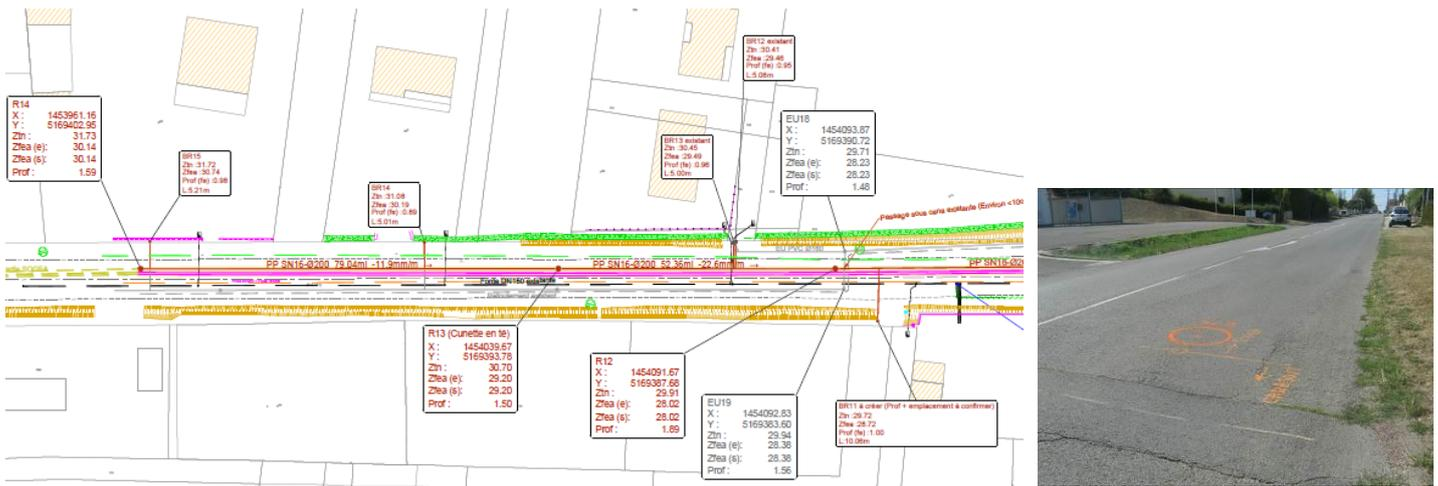
Pour le réseau d'eau potable, poursuite de la pose de la canalisation fonte DN 250 + canalisation fonte DN 200 en attente à partir de la rue des Épiciers. La localisation du branchement du château (en Ø 40) est à confirmer => **vu sur site le 12/10 par le MOE et l'exploitant.**
